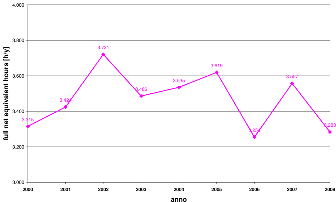
Grafico 5-4 Ore equivalenti medie annuali per aerogeneratore da 6 MW – dati satellitari QuikSCAT 00-08
