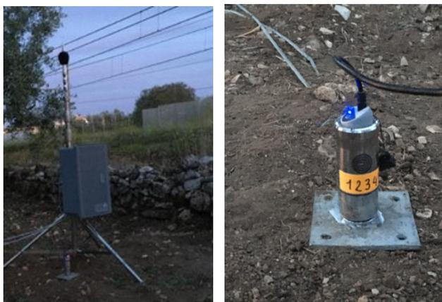
Figura 3-3 Esempio di installazione dell'accelerometro
