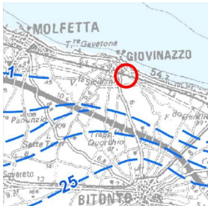
Figura 5-22 Andamento delle linee piezometriche (Fonte: Piano Indagini della “Bonifica ed il ripristino ambientale delle ex Acciaierie e Ferriere Pugliesi in area Lama Castello – Progetto esecutivo lotto II”)
