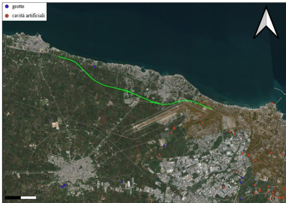
Figura 5-7 Immagine aerea dell'area di studio con il Catasto delle Grotte e delle Cavità Artificiali della Puglia della Federazione Speleologica Pugliese (aggiornato a gennaio 2021). In verde è riportata la tratta in progetto
