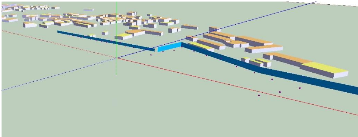
Figura 6-11 Modellazione tridimensionale in presenza di interventi di mitigazione acustica
