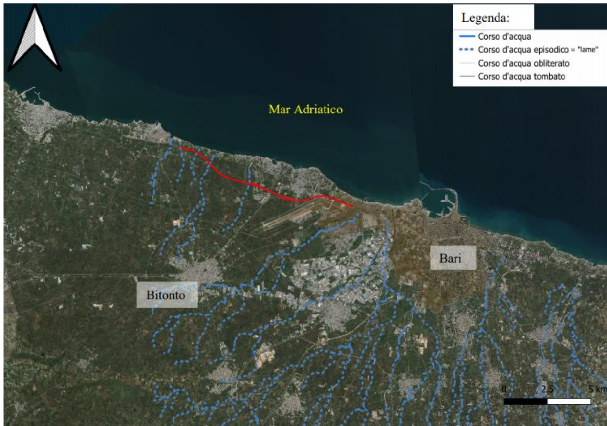
Figura 9 Reticolo idrografico della zona di Bari. Il tracciato di progetto in rosso. Fonte: SIT-Puglia 1
