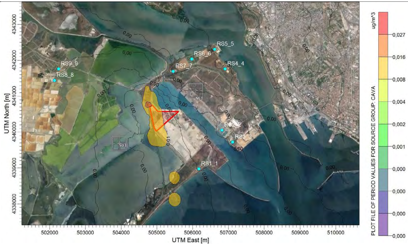
Figura 42. mappa di isoconcentrazione di PM 10 in medie annuali; contributo del trasporto di materiale dalla cava di Sarroch
