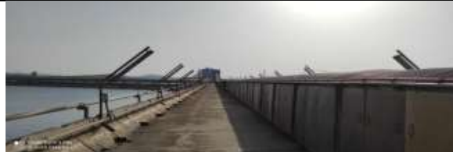
Figura 18 Linea Carbone nastro trasportatore completamente chiuso sullo sfondo torre di distribuzione
