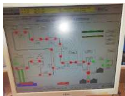
Figura 38 Sala manovra carbone: schermata funzionamento nastri partita esterna
