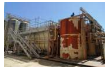
Figura 45 impianto trattamento acque spurghi deSOx, particolare dell'impianto di riduzione del selenio
