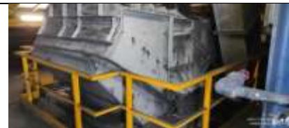
Figura 21 torre di distribuzione, T8 scuotitore tramoggia sopra vaglio
