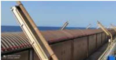
Figura 17 Linea Carbone nastro trasportatore completamente chiuso
