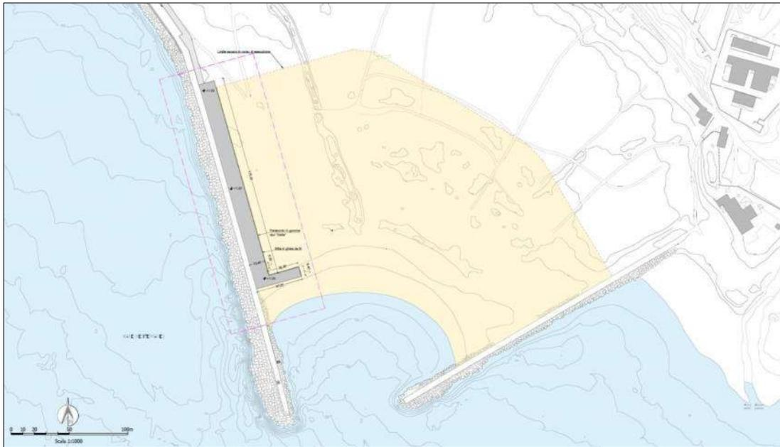
*Figura 4: Planimetria con banchina realizzata via terra*
