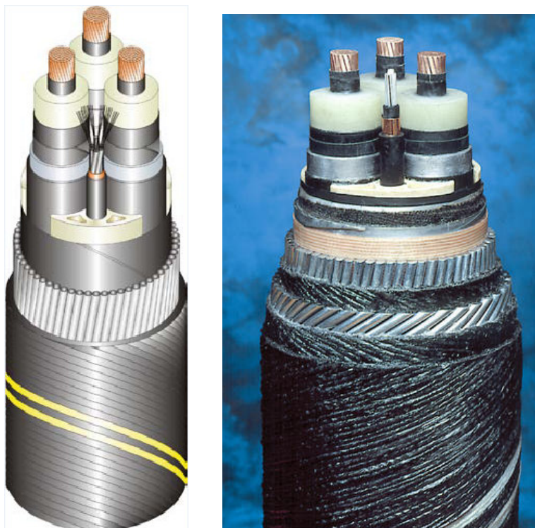
Figura 2-9 sezione tipica del cavo marino XLPE tripolare in rame, con schermi in piombo, armatura in acciaio e fibra ottica
