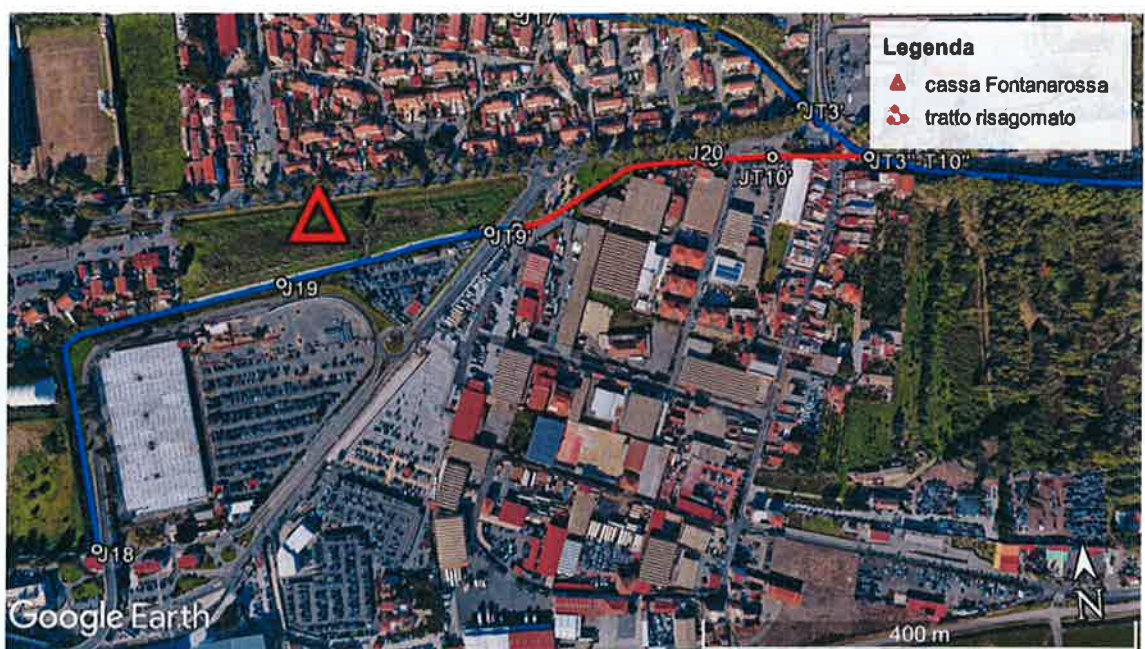
Figura 7.3. Dettaglio degli interventi di mitigazione previsti per il F. Fontanarossa.
