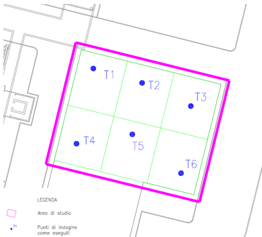
Figura 6.1: Ubicazione dei Punti di Sondaggio Ambientale nell'Area ex Macchi 3
