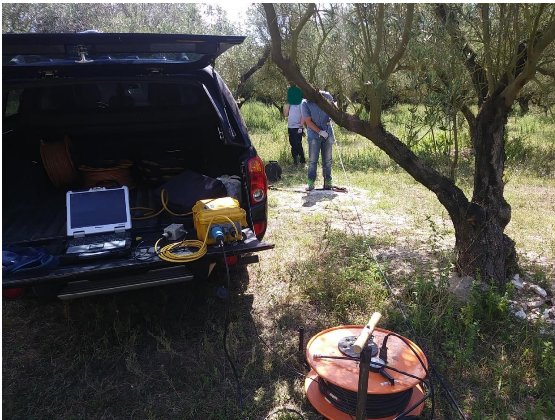
Figura 31 Esecuzione dell'indagine DOWN-HOLE n. 1
