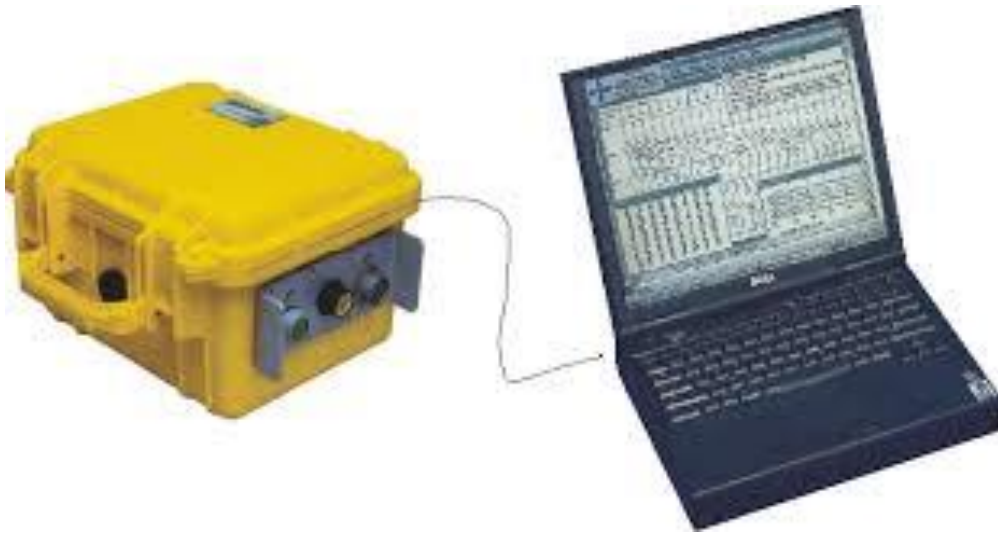
Figura 4 – Sismografo Geometrics utilizzato per effettuare le indagini di sismica Down-hole.
