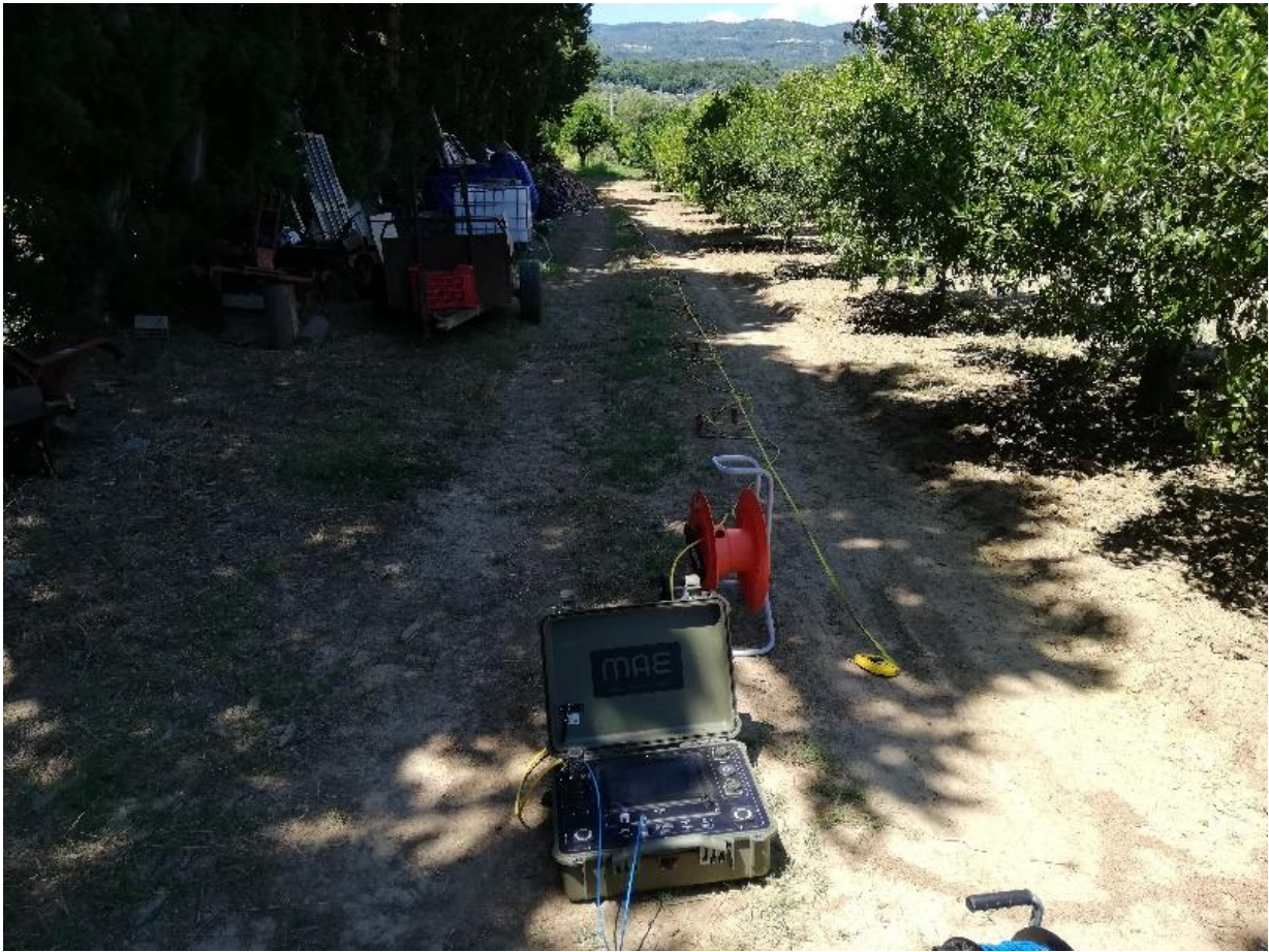
Figura 25 - Esecuzione delle indagini MASW
