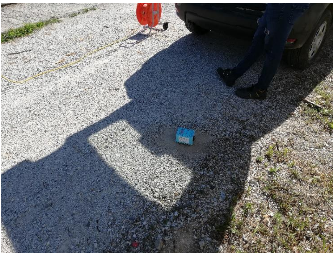
Figura 11 - Esecuzione dell'indagine HVSR.
