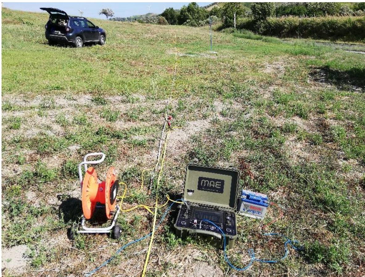
Figura 13 - Esecuzione delle indagini MASW
