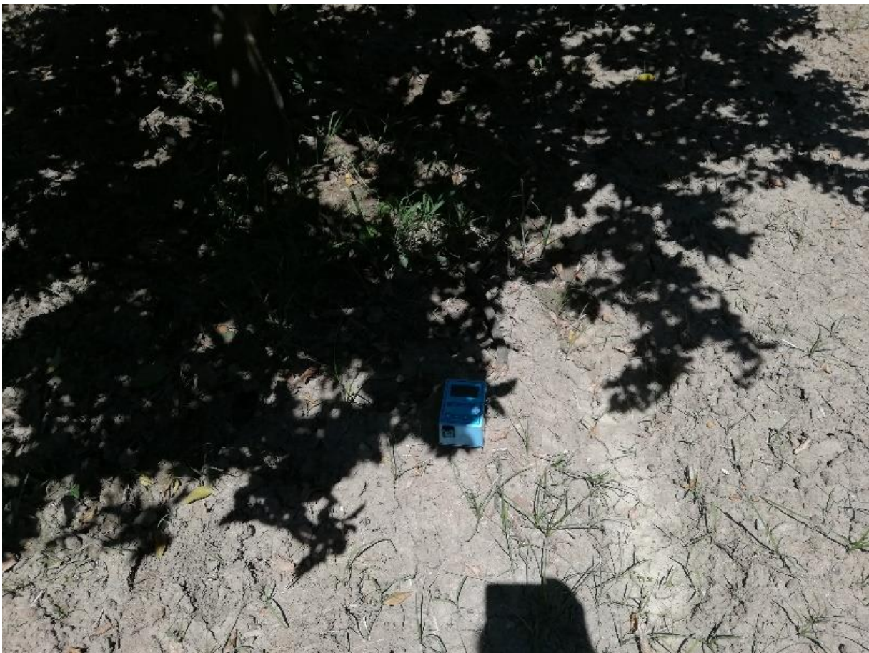
Figura 29 - Esecuzione dell'indagine HVSR.
