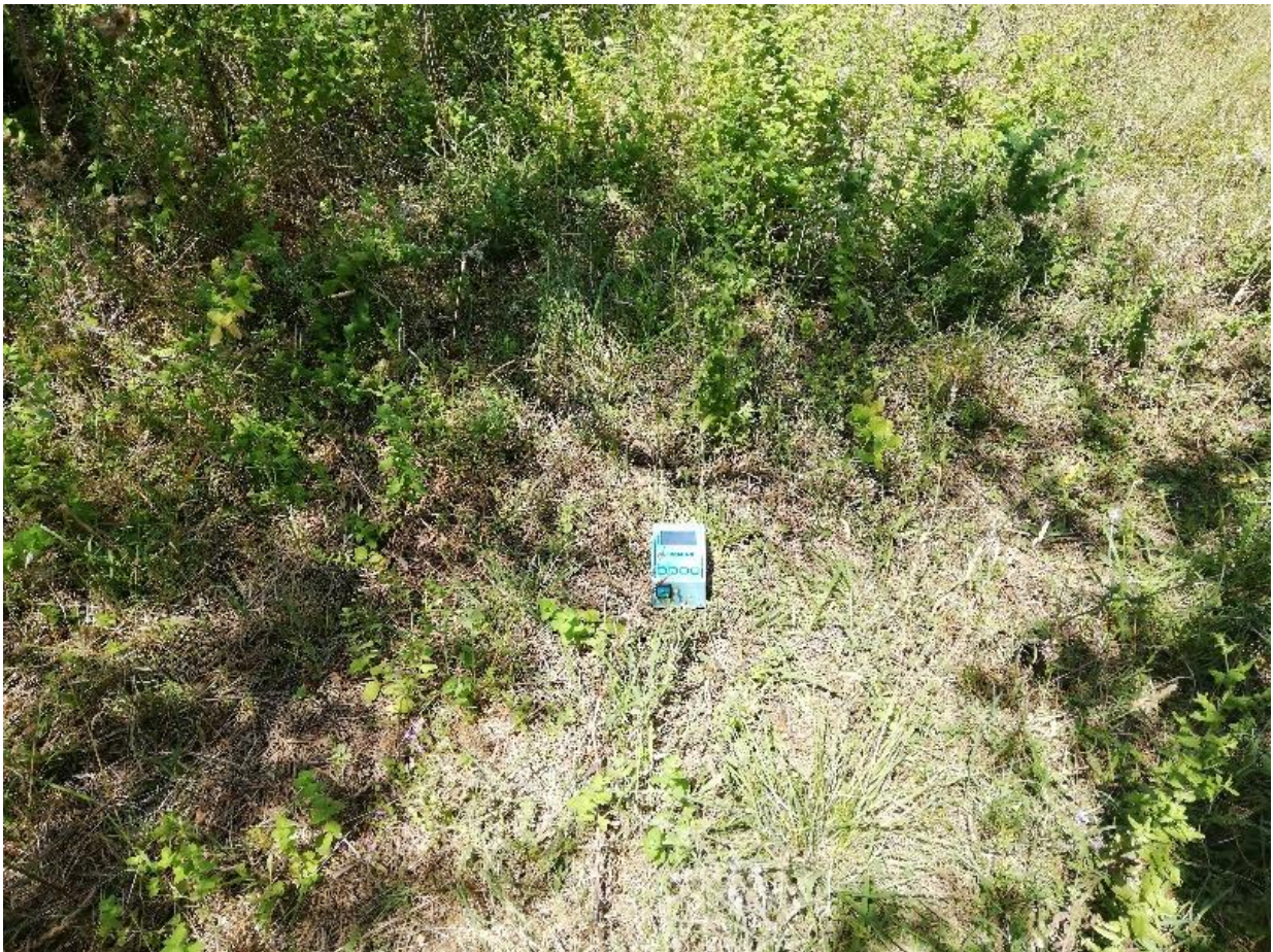
Figura 23 - Esecuzione dell'indagine HVSR.
