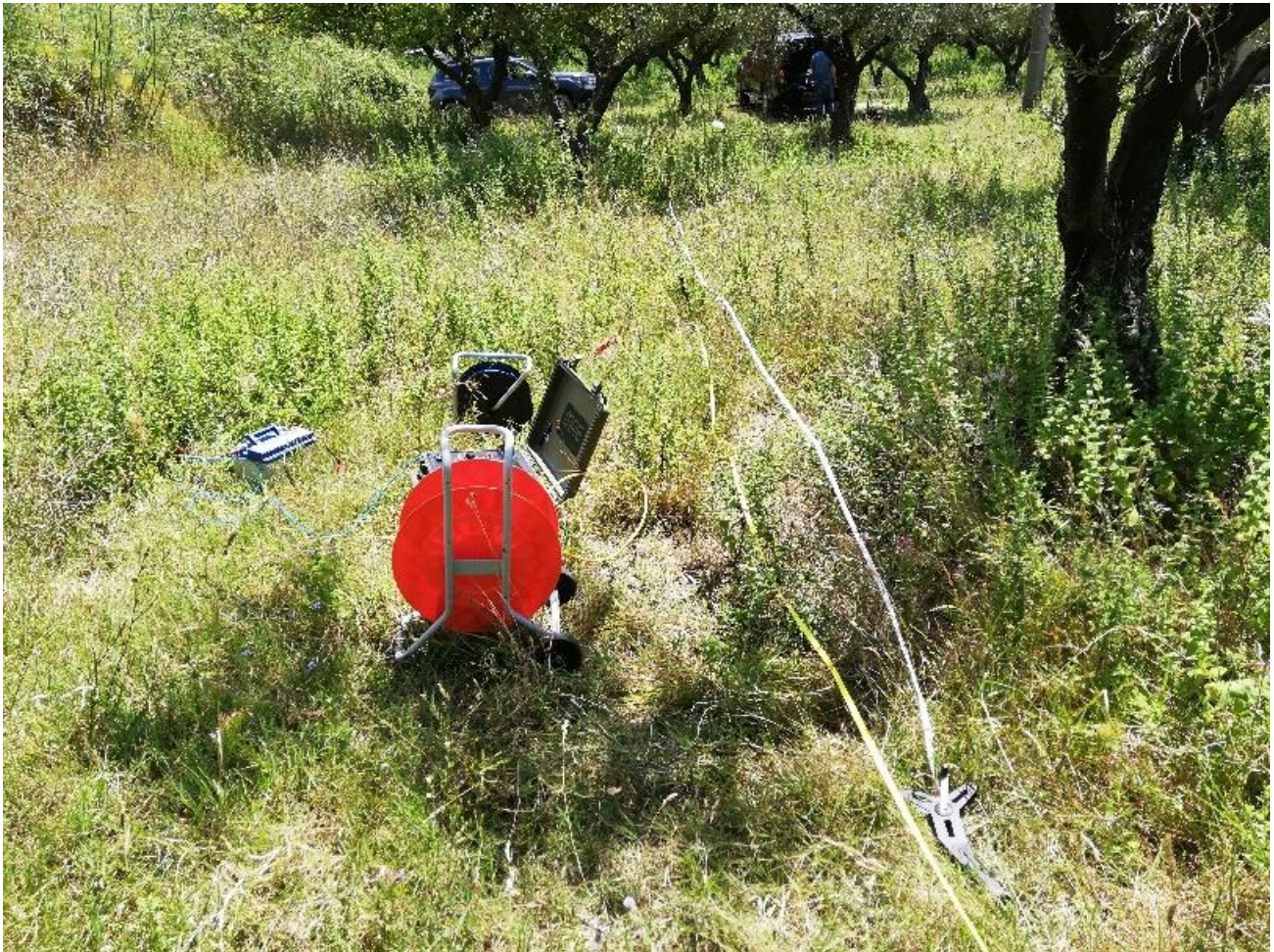
Figura 19 - Esecuzione delle indagini MASW
