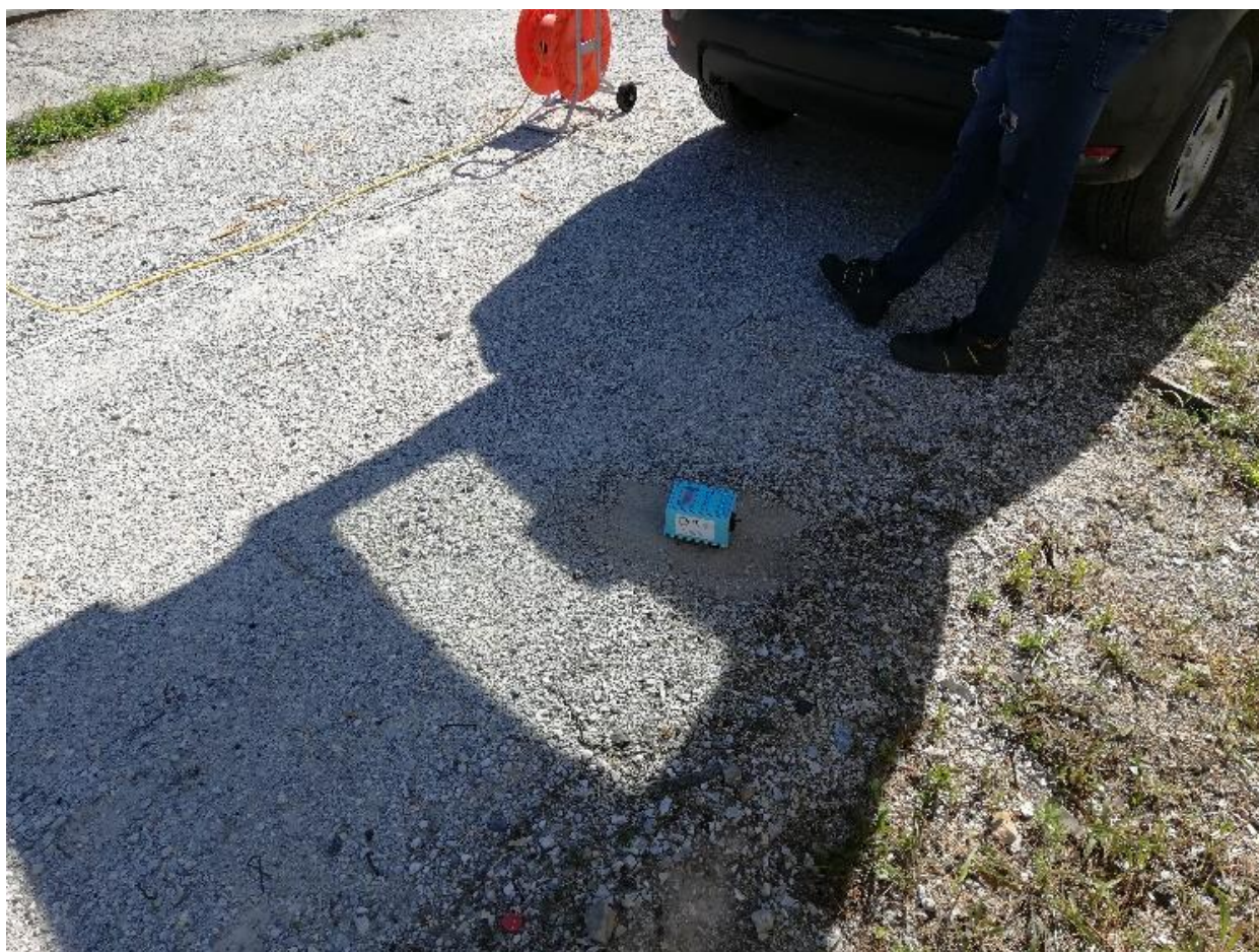
Figura 32 - Esecuzione dell'indagine HVSR.
