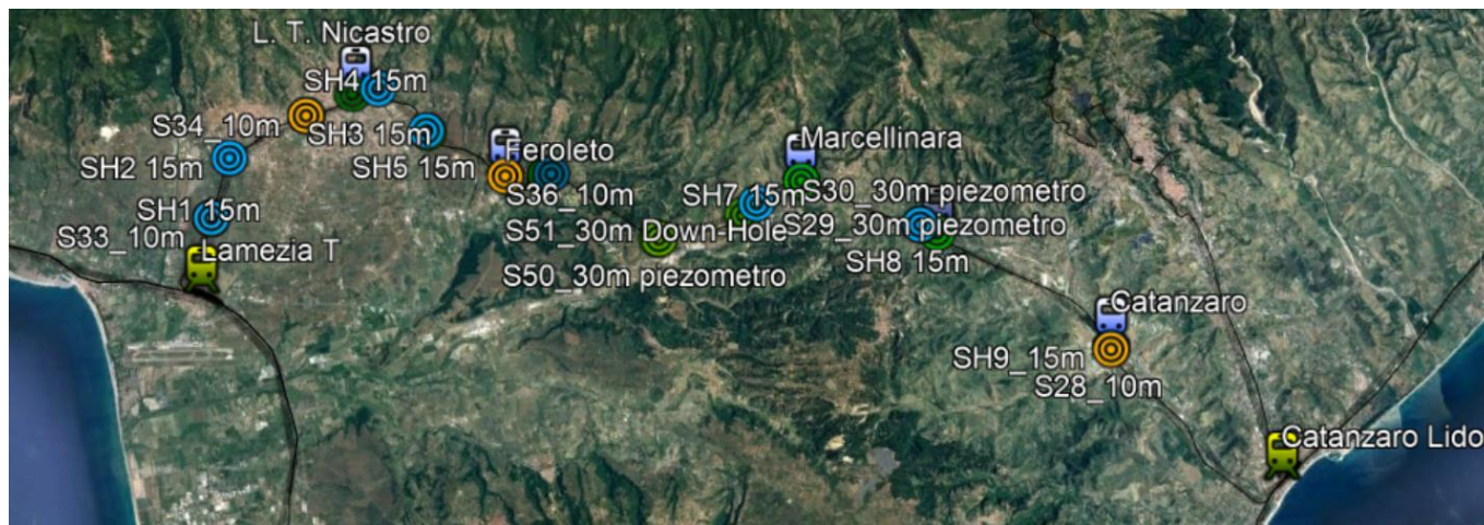
Figura 1: Inquadramento della linea ed ubicazione dei sondaggi
