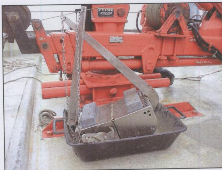
Fig. 2 – Benna Van Veen utilizzata per i prelievi di macrozoobenthos.
