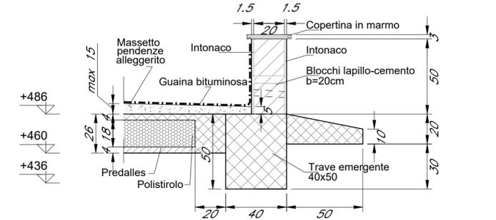
**SEZIONE AA'-Trave di copertura tipo longitudinale**
