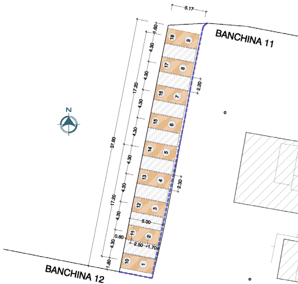
Figura 10: Banchina 12 – Disposizione elementi strutturali
