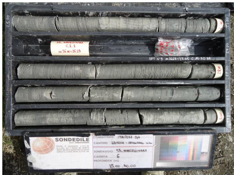
Figura 23 – Ma – Formazione gessoso-solfifera nel foro di sondaggio S5, tra i 25 ed i 30 m da p.c.
