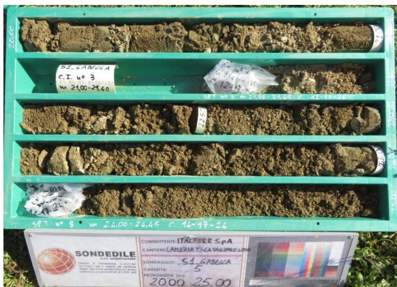
Figura 4 – Sabbie e arenarie tenere nel foro di sondaggio S1 tra 20 e 25 m da p.c.
