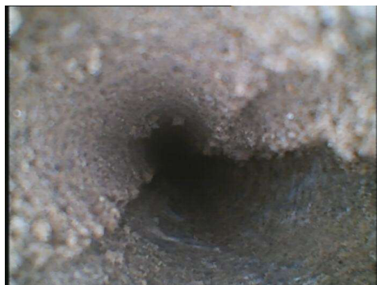
0,90 m: limite rivestimento
