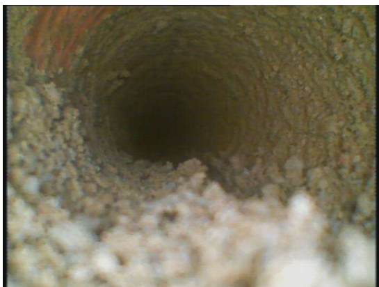
0,60 m: limite rivestimento
