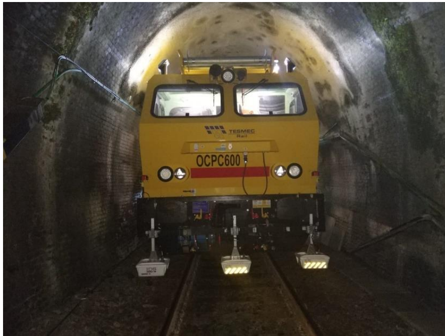
Figura 6: Acquisizione Georadar con sistema IDS Safe Rail System
