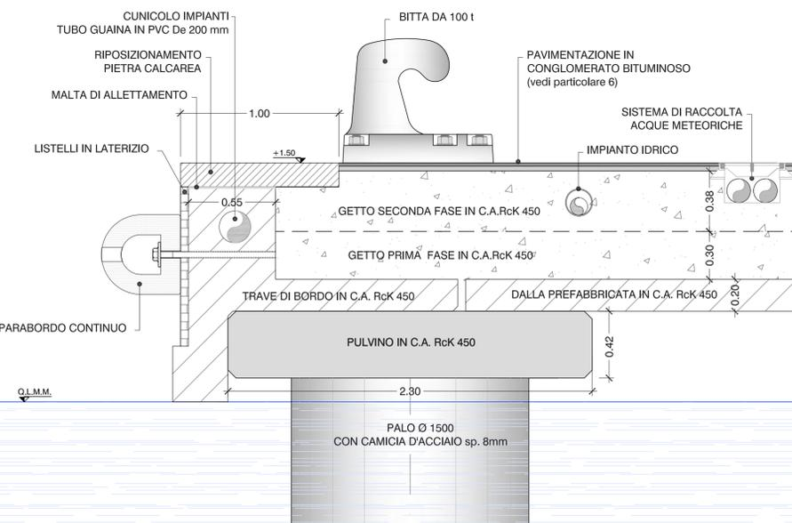
**PARTICOLARE 6 PAVIMENTAZIONE NUOVA SOVRASTRUTTURA**
