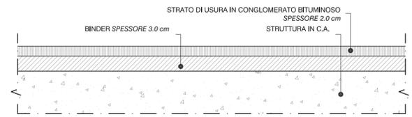
**PARTICOLARE 7 PAVIMENTAZIONE BANCHINA ESISTENTE**
