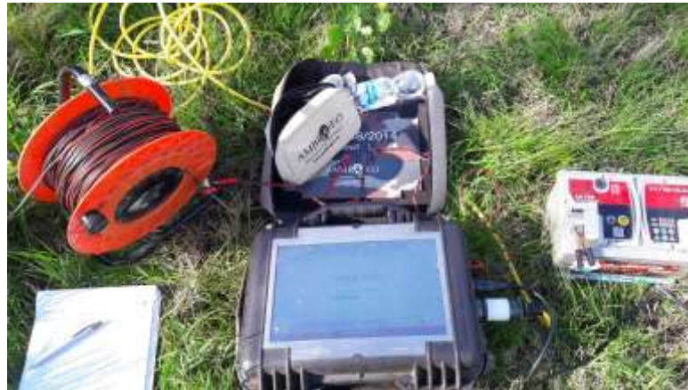
Figura 2.1.1.1: Sismografo digitale a 24 bit.
