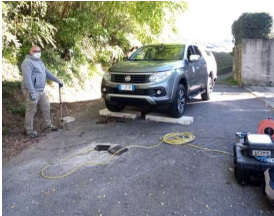
Figura 2.2.2.1: configurazione standard per le indagini Down Hole
