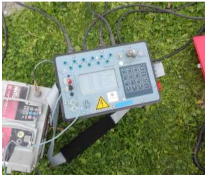
Figura 2.1.1.1: Georesistivometro - Syscal Pro (Iris Instruments- FRA).
