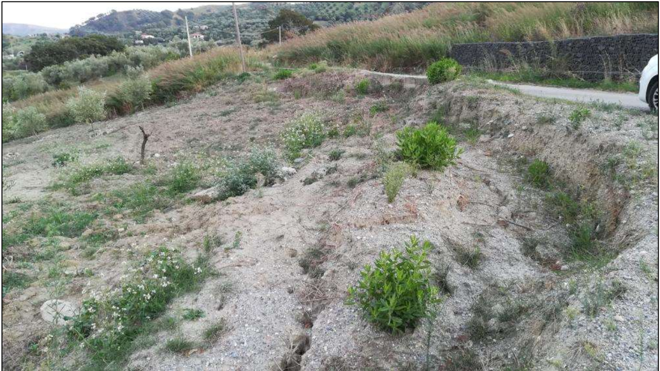
Figura 11-49 - particolare di una nicchia di frana di recente formazione, ha una larghezza di alcune decine di metri e con una scarpata di ordine decimetrico. A monte è visibile una gabbionata in pietra per proteggere la strada.
