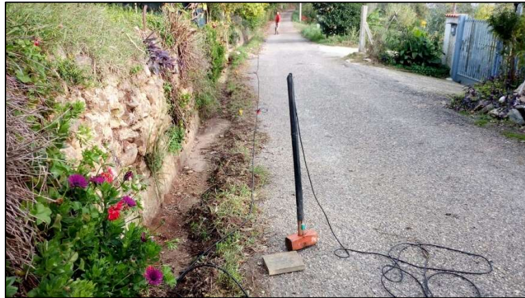
Figura 12-14 - foto del profilo sismico rifrazione n. 7
