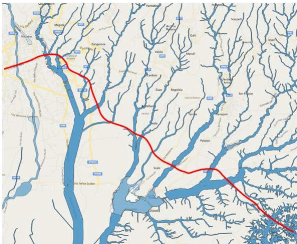
Figura 5-13 Stralcio della cartografia PAI del 2016 della pericolosità idraulica tra Quote Barile e Nicastro.
