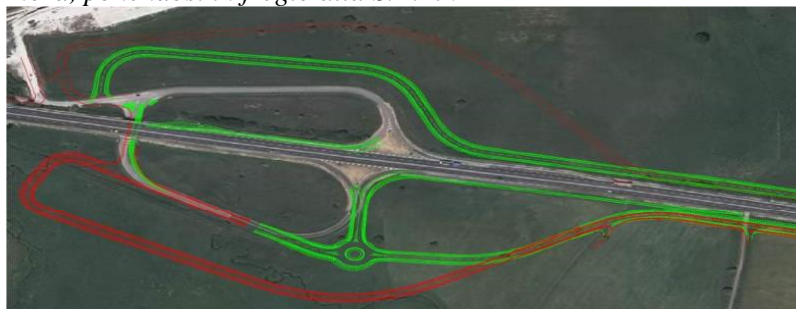
Figura 12 Risoluzione accessi C. N. dal Km 151+850 al Km 154+950_ tratto iniziale in approccio allo Svincolo di Campeda – Sovrapposizione del tracciato di PD (in rosso) con quello di PE (in verde)
