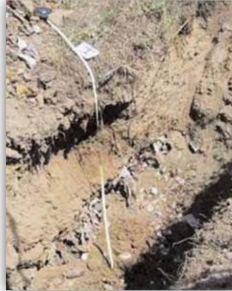
Figura 8-3: Scavo realizzato con pala meccanica. Consente di osservare la sequenza litologica sulle pareti dello scavo stesso e di verificare la presenza di una falda superficiale.
