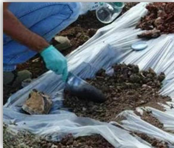
Figura 5-3: Deposito materiale scavato e Campionamento terre.
