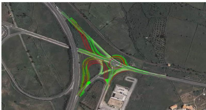
Figura 6 Adeguamento svincolo Macomer – Sovrapposizione del tracciato di PD (in rosso) con quello di PE (in verde)
