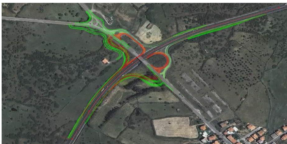
Figura 5 Adeguamento svincolo di Paulilatino – Sovrapposizione del tracciato di PD (in rosso) con quello di PE (in verde)
