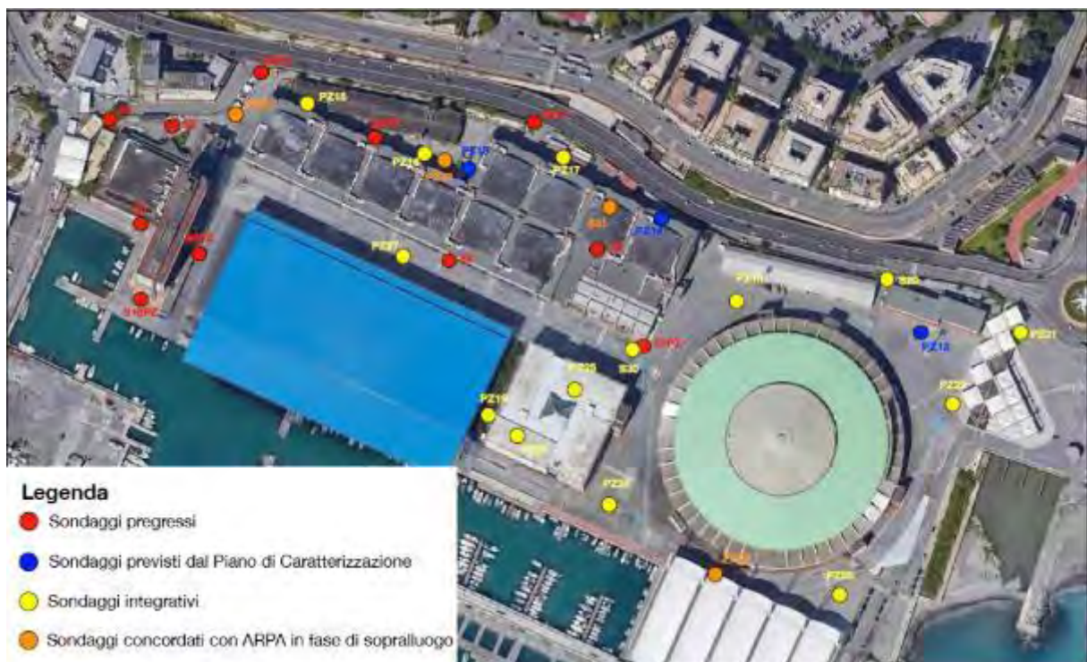
Figura 8-7 – Ubicazione sondaggi e piezometri PdC area Waterfront di Levante
