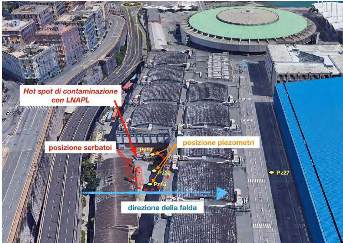
Figura 8-8 – Individuazione dei punti in cui le analisi hanno evidenziato la presenza di LNAPL.
