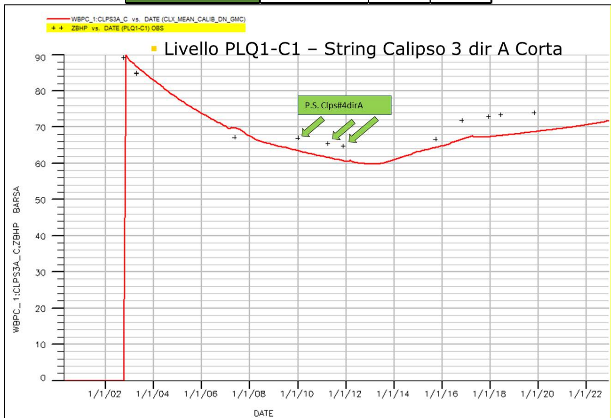
Figura 7 - Campo di Calipso: pressioni statiche misurate e modello Eclipse 2017 (livello PLQ1-C1)
