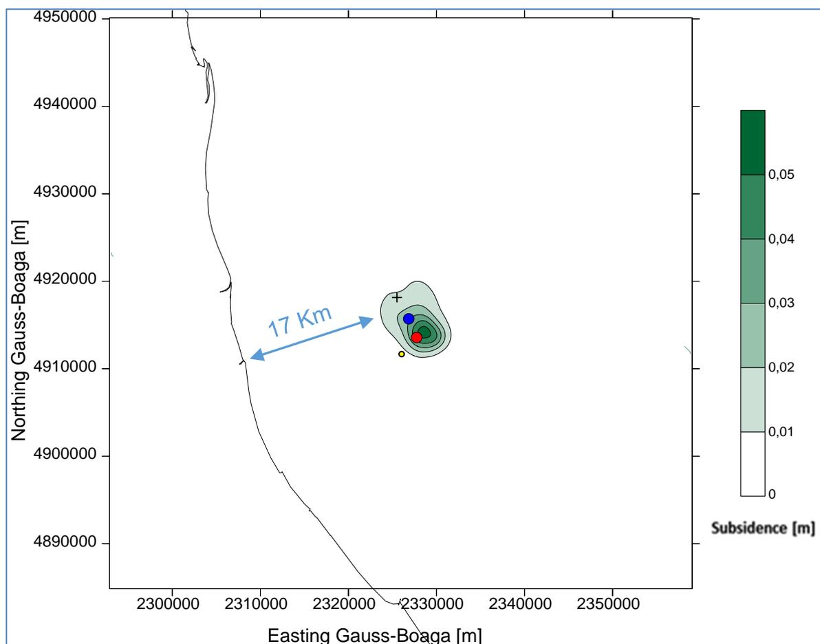
Figura 8 - Campo di Porto Corsini Mare: curve d'iso-subsidenza per lo scenario al 2020. Il simbolo a forma di croce indica la posizione della piattaforma PCC. I pozzi PCMS-1 e PCMS-2 sono indicati rispettivamente da un cerchio rosso e uno blu.
