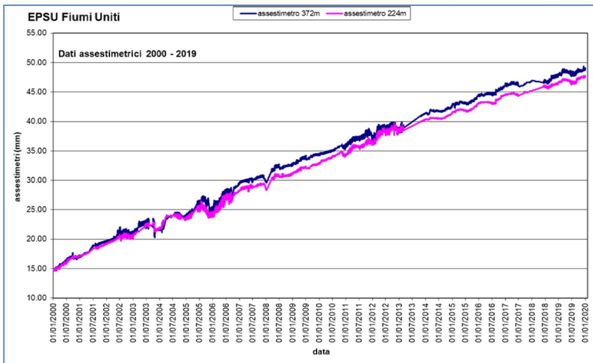
**Figura 16B - Curva di compattazione degli assestimetri della stazione EPSU di Fiumi Uniti (dati 2000-2019)**
