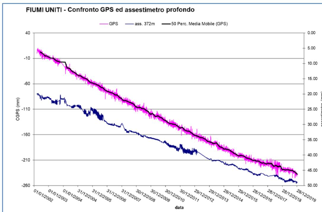
**Figura 19B - Confronto fra misure da CGPS vs. misure di compattazione (Assestimetro profondo della stazione EPSU di Fiumi Uniti)**
