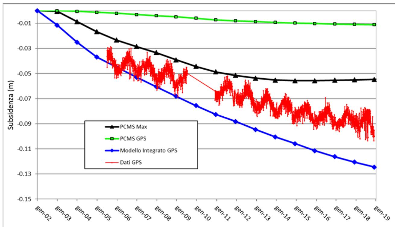
Figura 12 - Campo di Porto Corsini Mare: CGPS (agg. 31 dic. 2019) vs. modello di subsidenza (in corrispondenza della p.ma PCC)
