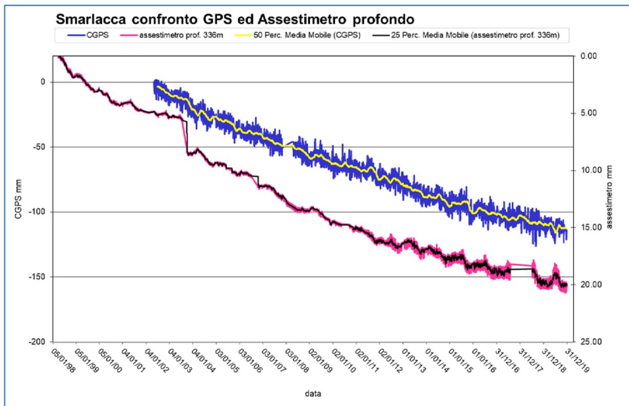
**Figura 7B - Confronto fra misure da CGPS vs. misure di compattazione (assestimetro profondo della stazione EPSU di Smarlacca)**
