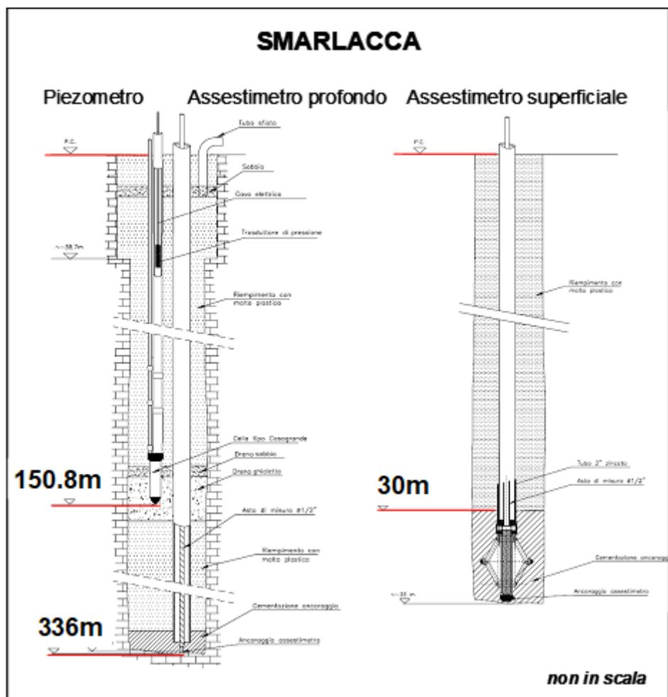
Figura 3B - Schema della stazione EPSU di Smarlacca
