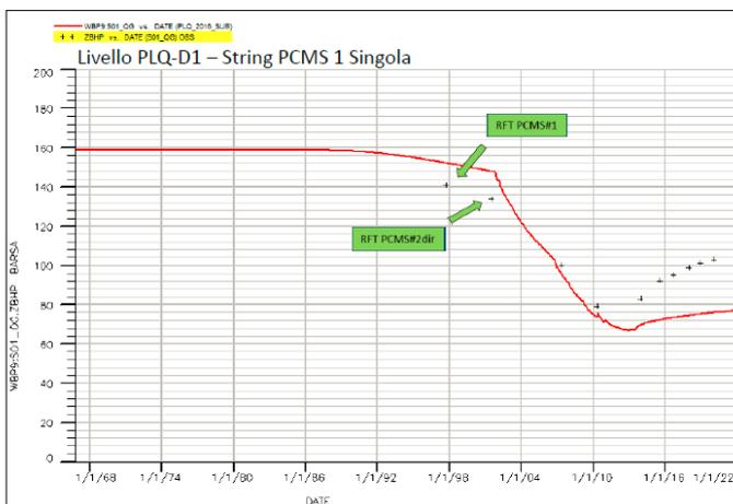
Figura 7 - Campo di Porto Corsini Mare: confronto tra i dati di pressione da profili statici e modello Eclipse 2016 (livello PLQ-D1)
