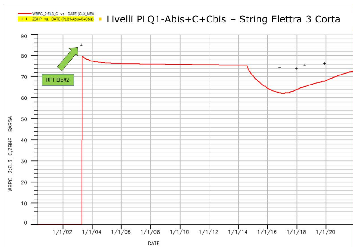
Figura 7 - Campo di Elettra: confronto tra dati di pressione da profili statici e modello Eclipse 2017 (liv. PLQ1-Abis+C+Cbis)
