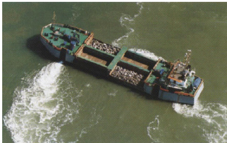
Fig. 5.2 - Imbarcazione utilizzata per la messa in opera a mare del materiale ghiaioso e pietrisco.
