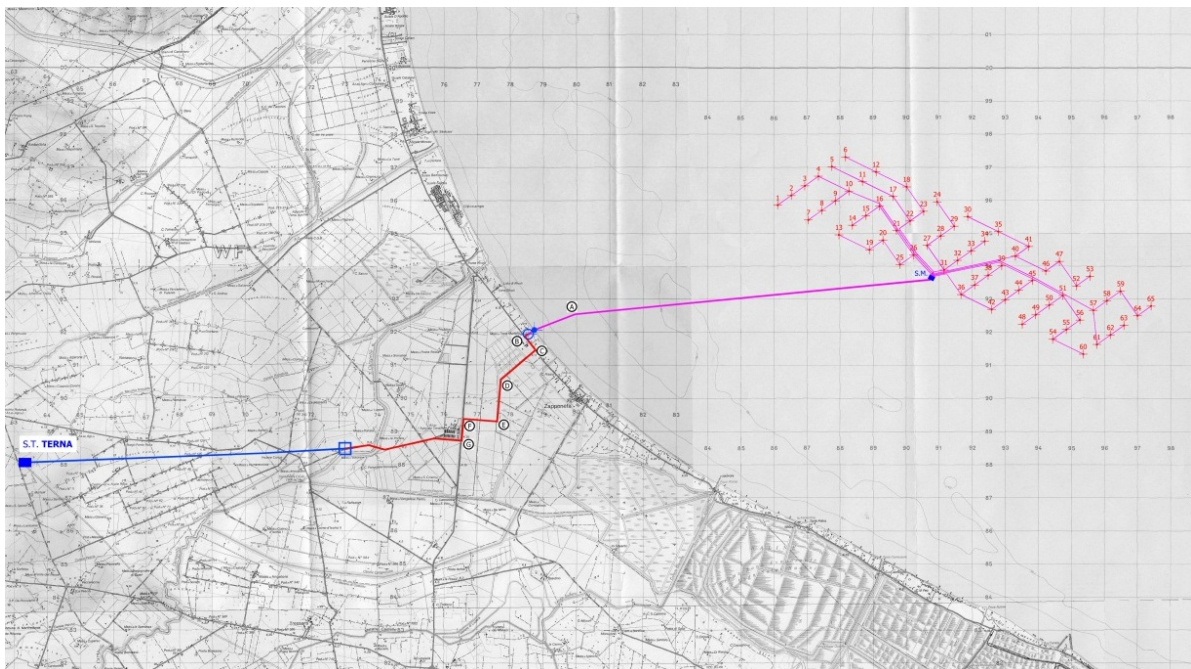
Figura 4.5 – Schema generale della centrale eolica offshore del Golfo di Manfredonia su stralcio cartografia IGM 50.000.
