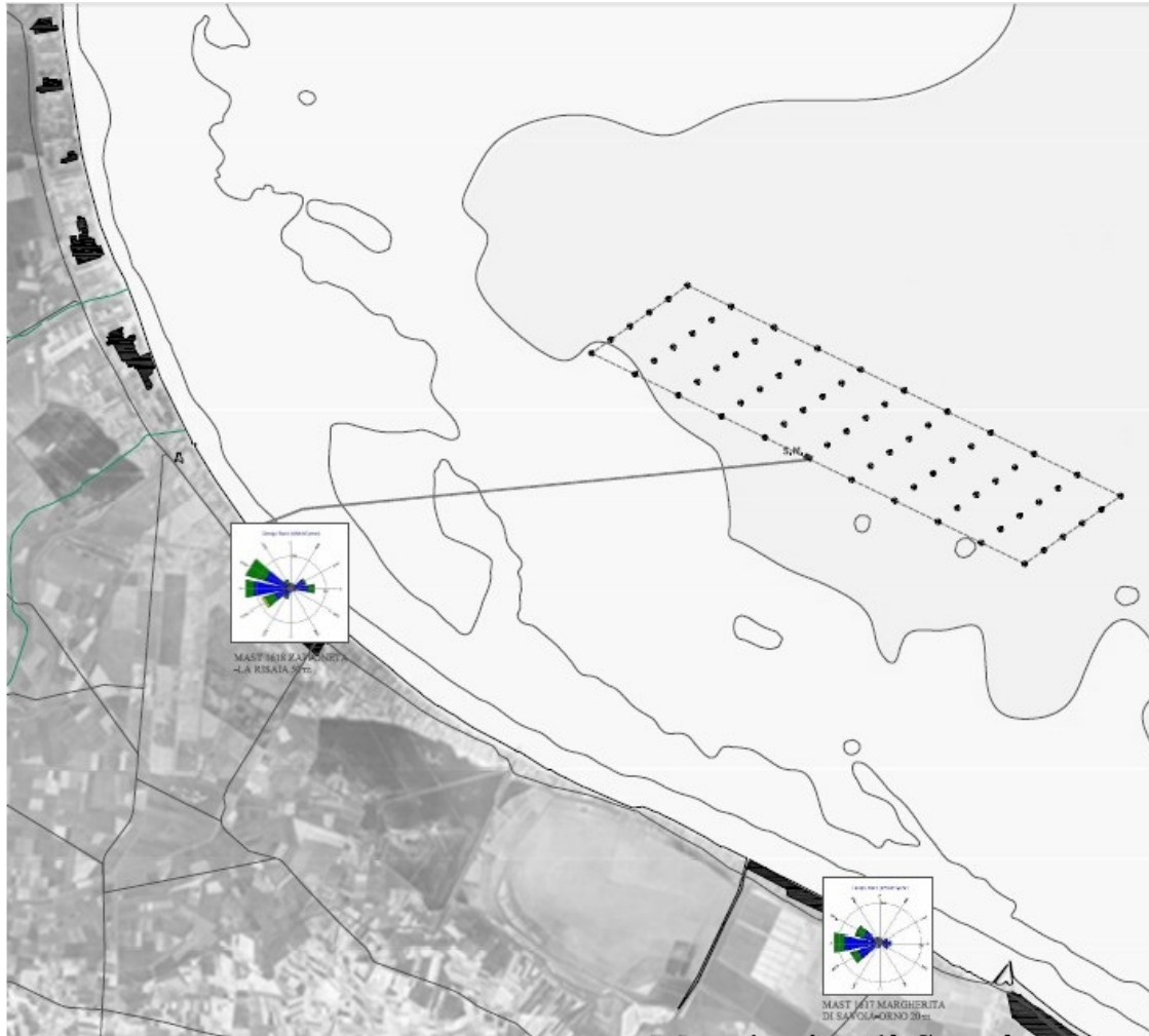
Figura 4.12 - Layout A centrale eolica off-shore
