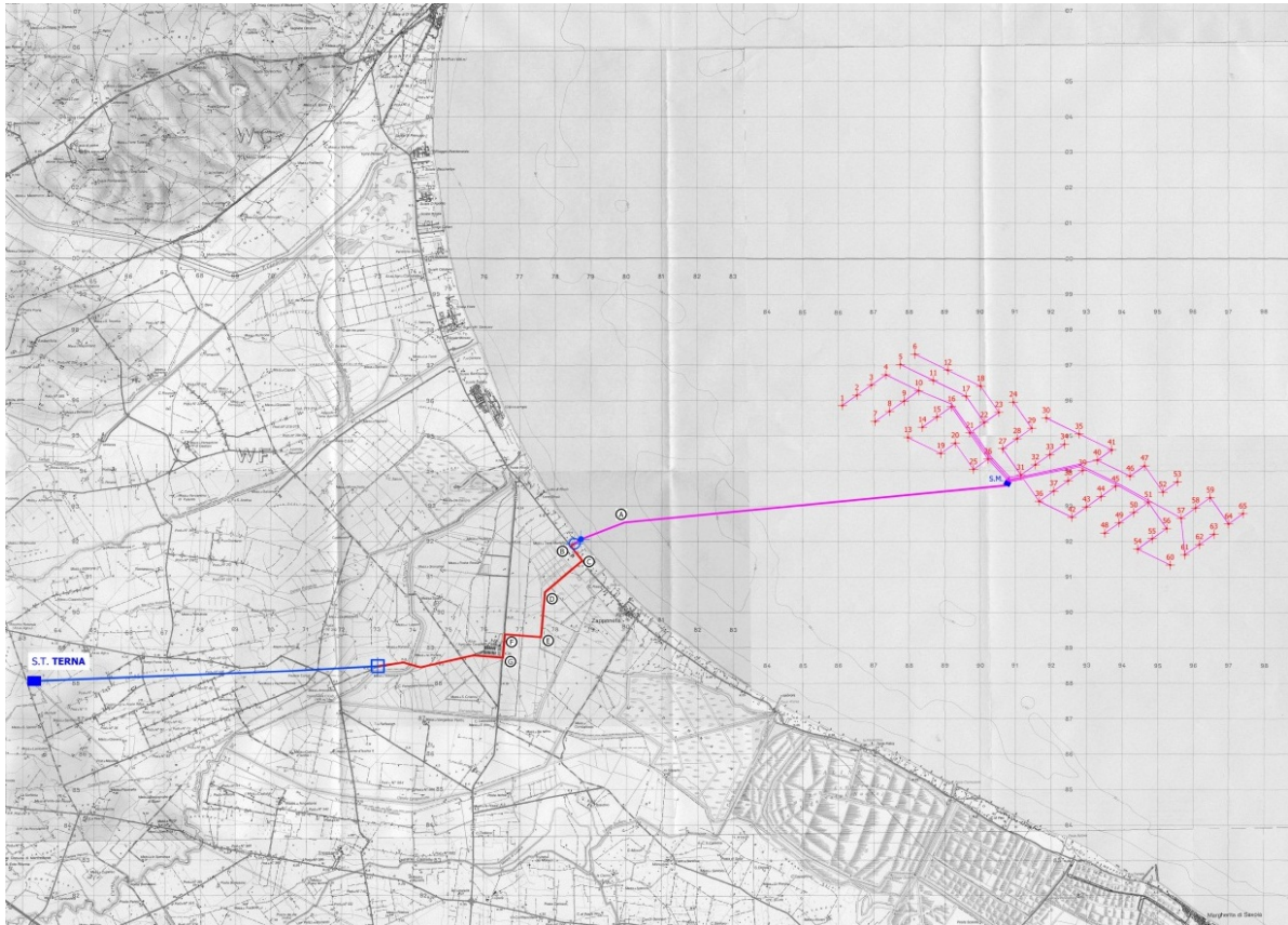
Figura 4.5 – Schema generale della centrale eolica offshore del Golfo di Manfredonia su stralcio cartografia IGM 50.000.
