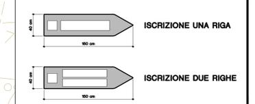
PREVEDERE IL DELINEATORE SPECIALE DI OSTACOLO ( COLORE GIALLO - H = 60 cm ) CON I SEGNALE INDICANTI PASSAGGI OBBLIGATORI O CONSENTITI POSTI SULLE TESTATE E CUSPIDI DI ISOLE DI TRAFFICO E SPARTITRAFFICO
