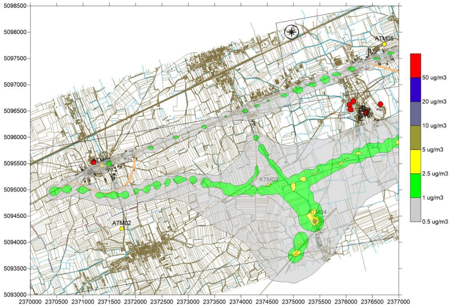
Figura Allegato 11 Scenario "post operam" - PM10 - 36° massimo media 24h - sezione W
