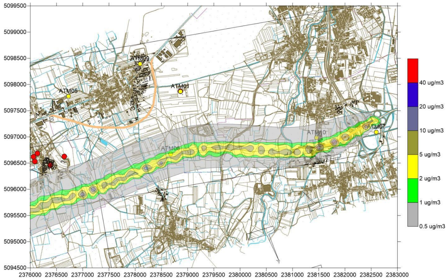
Figura Allegato 4 - Scenario cantiere settimana 59 - PM10 - media annua - sezione E
