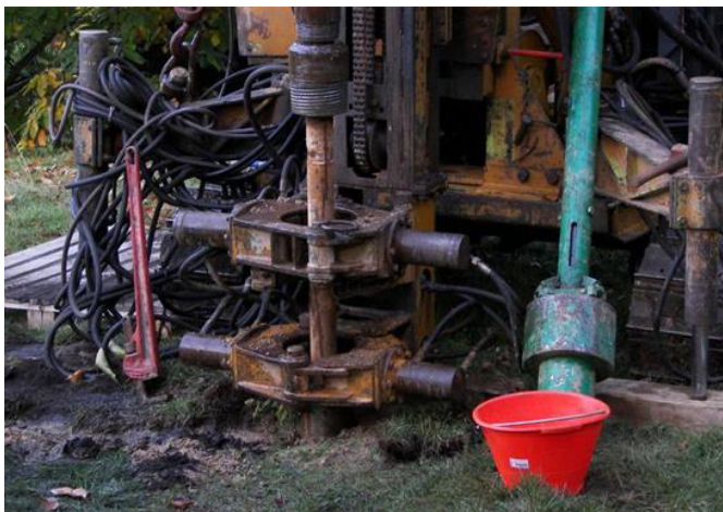
Figura 21: Macchina operatrice per la realizzazione di micropali tubfix. A sinistra sistema di scavo a rotopercussione, a destra sistema di scavo mediante trivella elicoidale.
