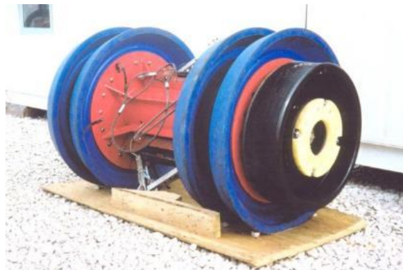
Figura 9-28 – Pig strumentale per il controllo della geometria e dello spessore della condotta
