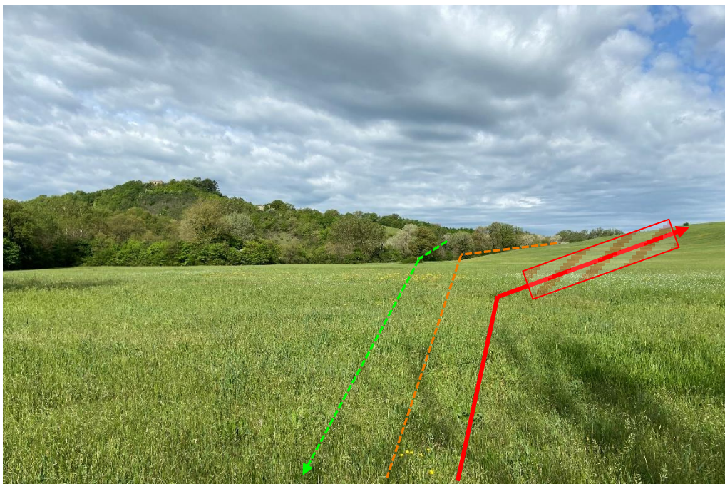
Foto n.36 – Percorrenza, in terreno agricolo, in stretto parallelismo con metanodotto esistente da dismettere e Metanodotto “Foligno-Sestino” in progetto da altra opera
