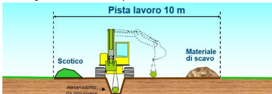
Figura 2-25 – Pista di lavoro per rimozione condotta esistente
