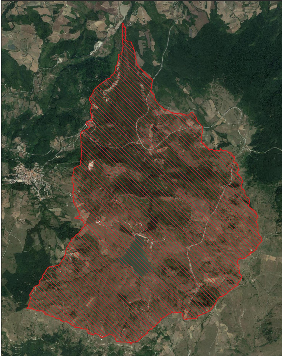
Figura 26 - Bacino imbrifero del torrente Ficocchia rispetto alla sezione di chiusura situata immediatamente a monte della confluenza del torrente Guana
