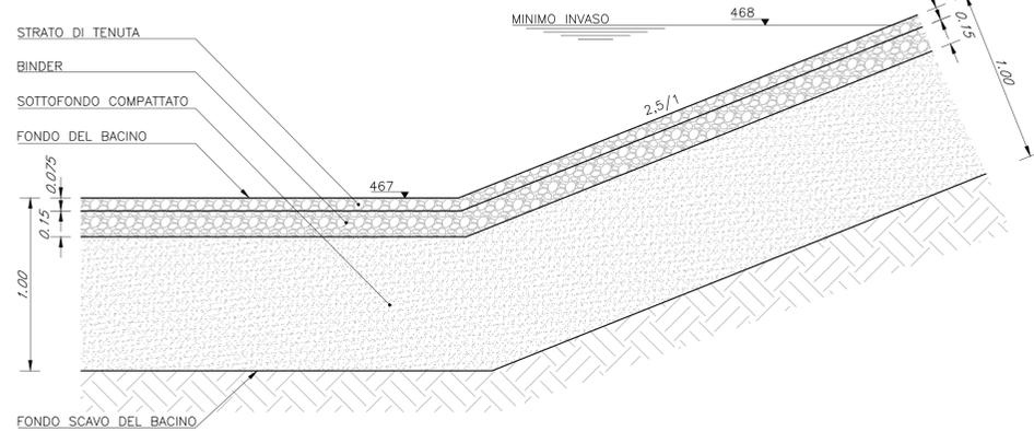
DETTAGLIO DEL MANTO IN CONGLOMERATO BITUMINOSO DELLA DIGA
