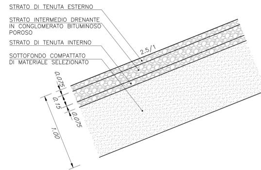
DETTAGLIO DELLA BANCHINA DI TRANSIZIONE - TIPO 1
