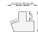
DETTAGLIO TUBAZIONE DI RACCOLTA DRENAGGI DEL MANTO
