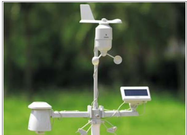
Figura 2 – Sensori esterni di rilevazione
