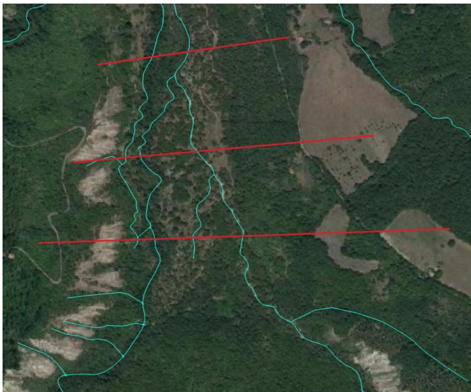
Figura 4.5: Opzione A: in Rosso le Sezioni valutate per l'Ubicazione della Diga, in Azzurro i Corsi d'Acqua Naturali segnalati dal Geoportale della Regione Basilicata
