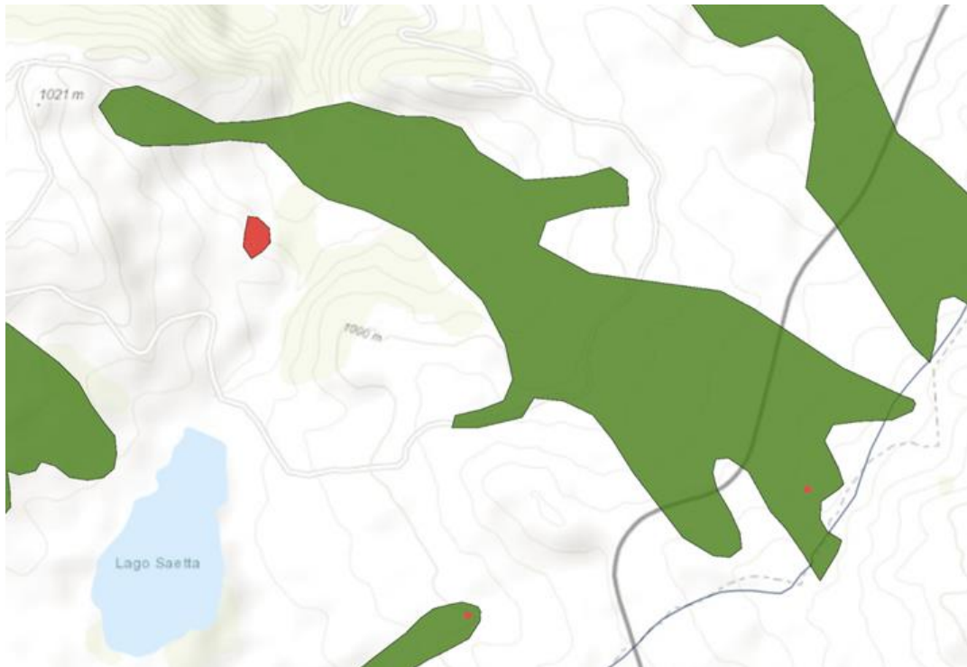
Figura 11 - Perimetrazione della frana riportata nel database IFFI, con indicazione del Punto Identificativo del Fenomeno Franoso (puntino rosso)
