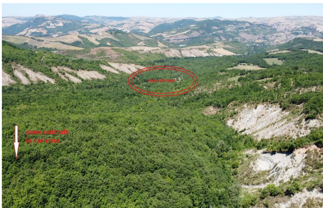
Figura 13 - Il graben nelle argille plioceniche delimitato simmetricamente da scarpate su cui si impostano esfoliazioni e morfologie calanchive
