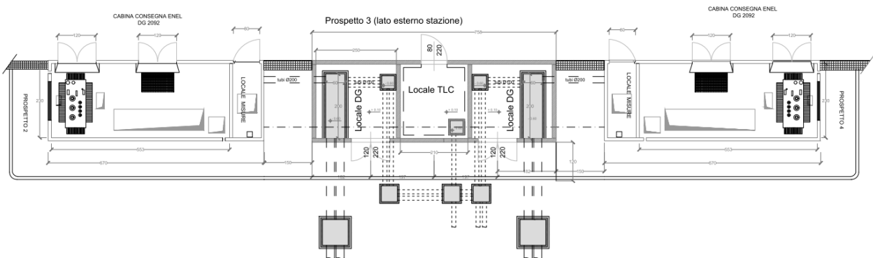
Figura 24: planimetria tipo dell'edificio consegna servizi esterni
