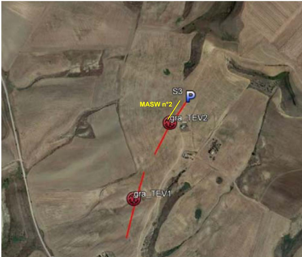
Figura 27. Gravina in Puglia. Area della condotta. Ubicazione del sondaggio S3, della MASW n°2 e delle TEV n°1 e TEV n°2.
