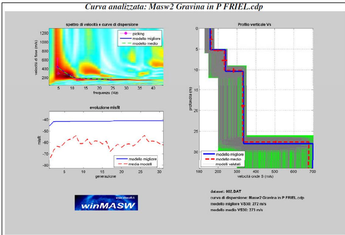
Figura 24. Gravina in Puglia. MASW n°2. Sintesi delle curve analizzate.
