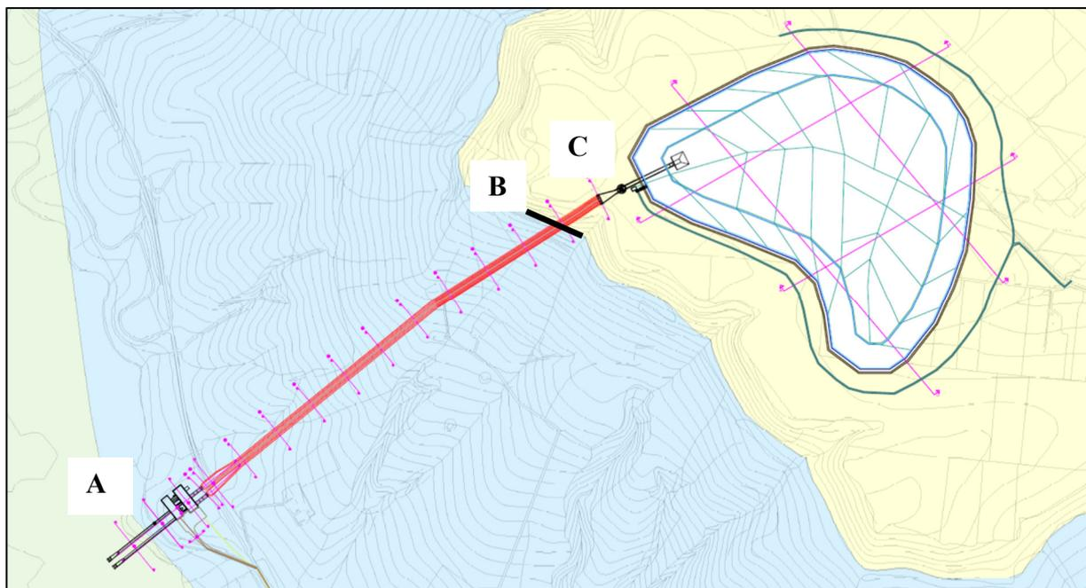
Figura 4. *Stralcio della carta geolitologica fuori scala con ubicazione della condotta forzata.*
