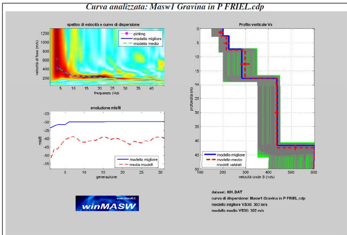
Figura 21. Gravina in Puglia. MASW n°1. Sintesi delle curve analizzate.
