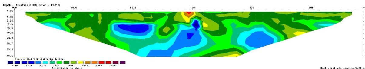
Figura 33. Gravina in Puglia. TEV n°4. Sezione geoelettrica analizzata.
