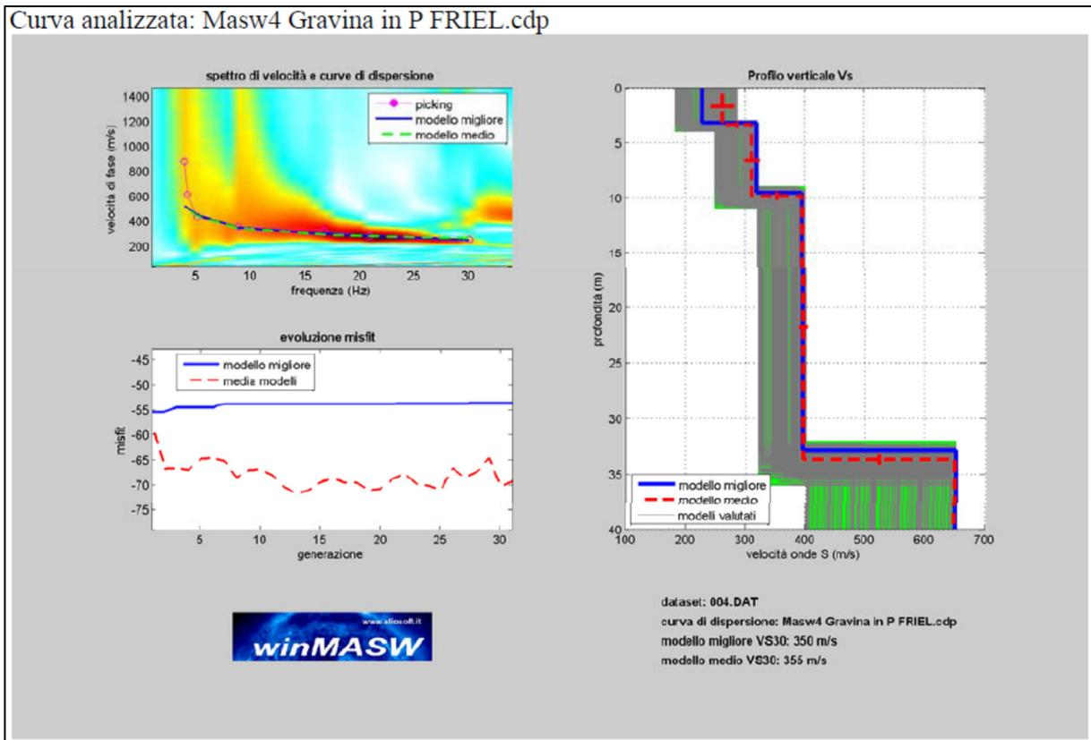
Figura 30. Gravina in Puglia. MASW n°4. Sintesi delle curve analizzate.
