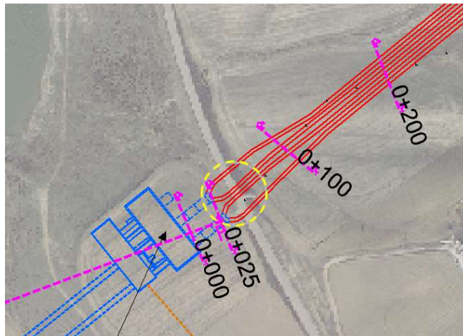
Figura 2. Intersezione tra il sistema di condotte forzate interrate e la strada poderale per Contrada Basentello nel Comune di Gravina in Puglia (BA).
