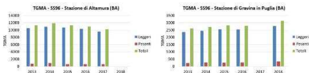
Figura 151. Traffico giornaliero medio annuo (TGMA) registrato lungo la SS96 presso le stazioni di Altamura (BA) e Gravina in Puglia (BA).
