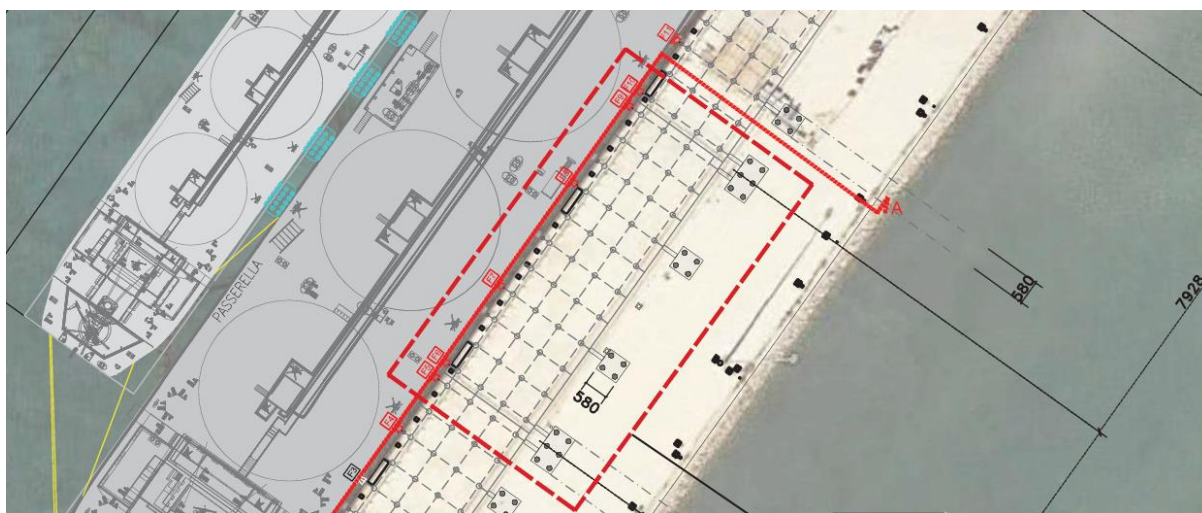
Figura 5.2 – Layout dei plinti del sistema di rinforzo fender (Doc. Rif. 100-CB-A-10041)
