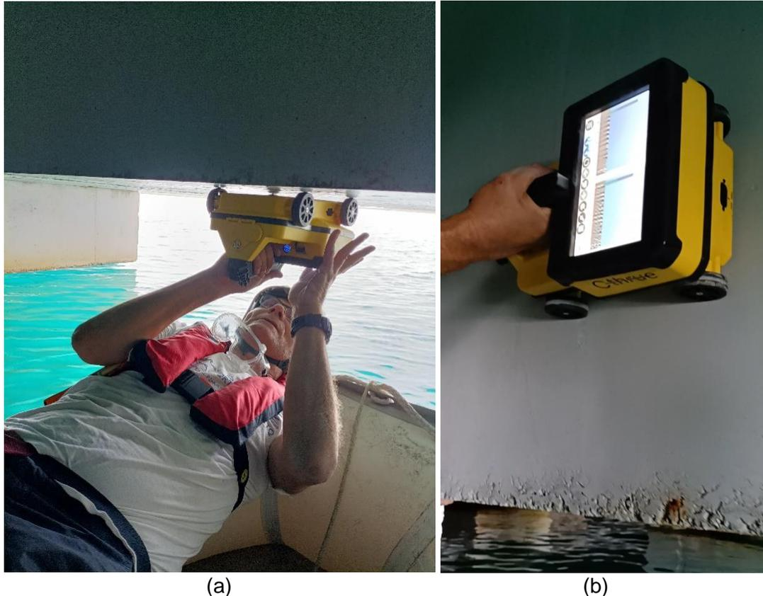
Figura 4.2 - Esecuzione prova con georadar su intradosso (a) e su parete della trave (b)
