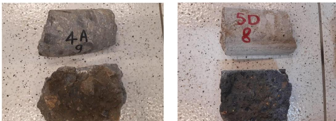
**Figura 4.14 - Provini sottoposti a prove colorimetriche attacco cloruri**
