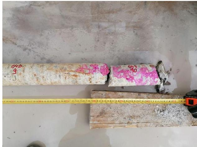
Figura 4.12 – Prova di carbonatazione su carota
