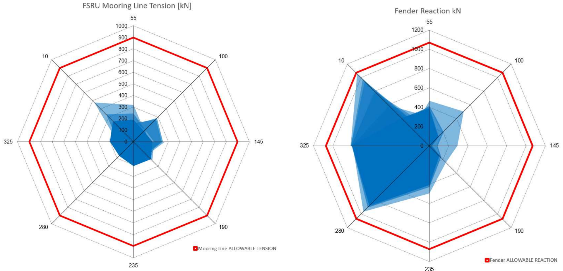
Figura 10-16 – Radar ormeggio nuovi arredi (DNV ALS - Tabella 9-4)
