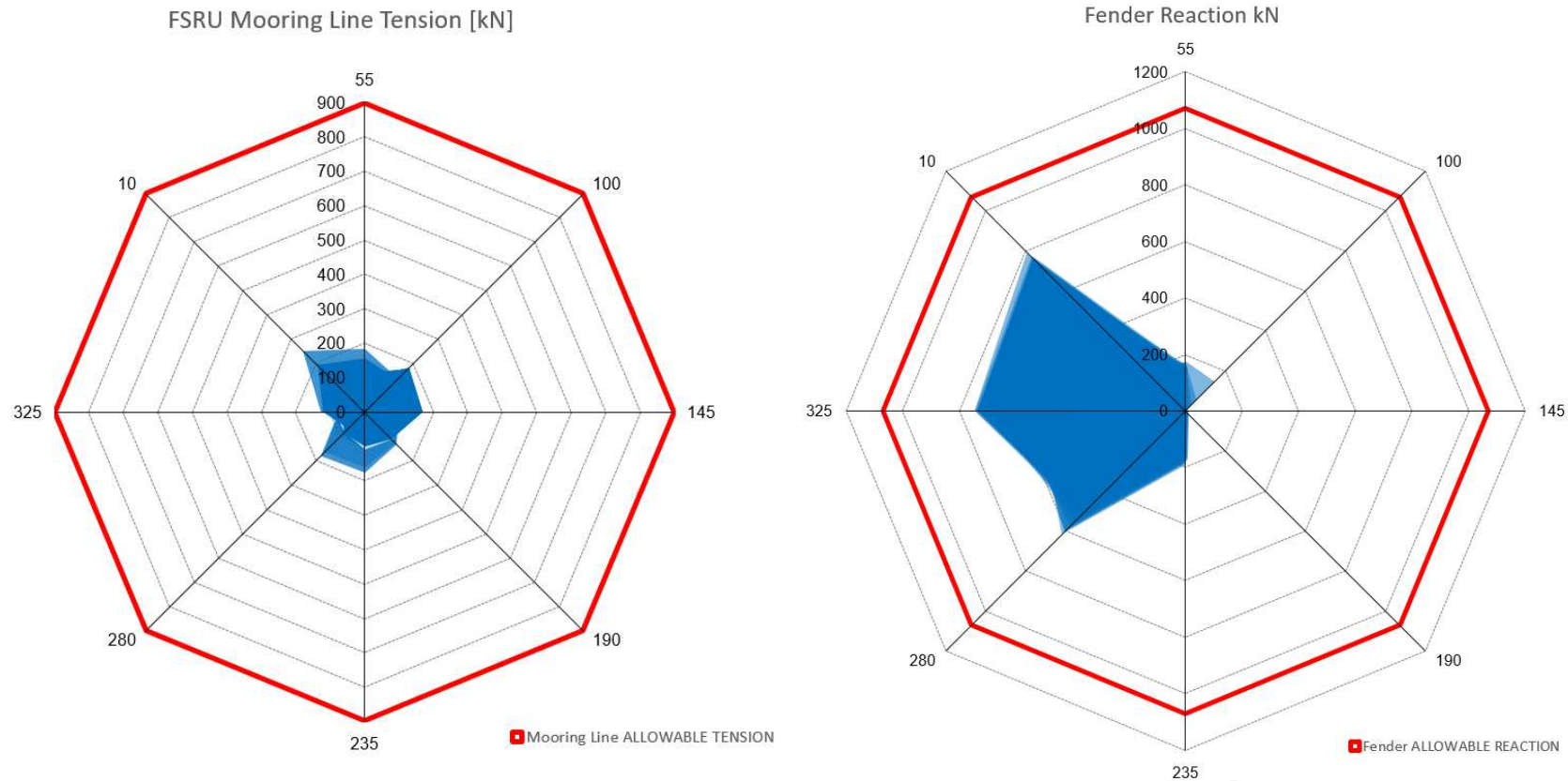
Figura 10-21 – Radar ormeggio nuovi arredi (DNV ALS - Tabella 9-5) – FSRU (INT.)
