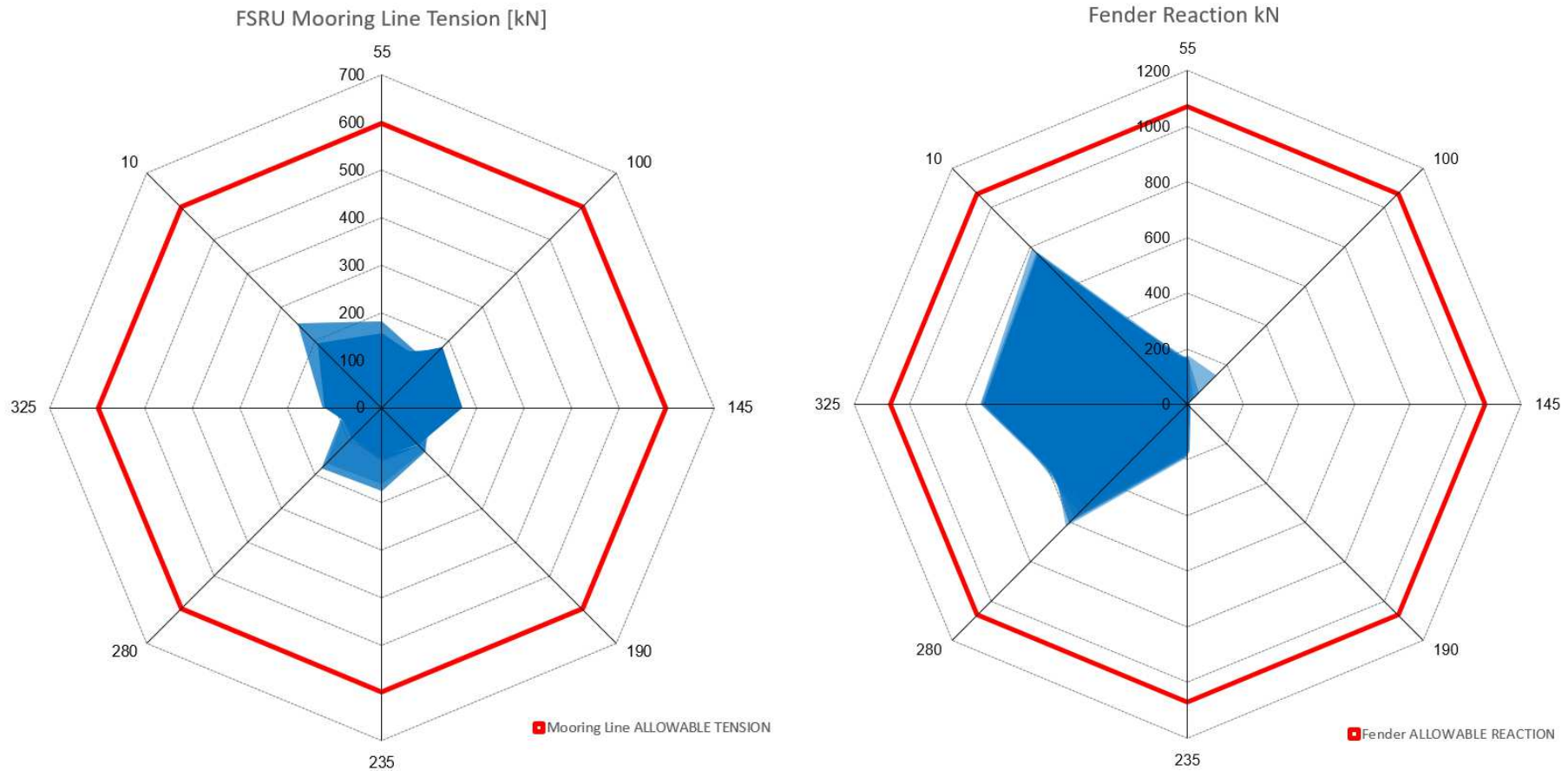
Figura 10-17 – Radar ormeggio nuovi arredi (DNV SLS - Tabella 9-5) – FSRU
